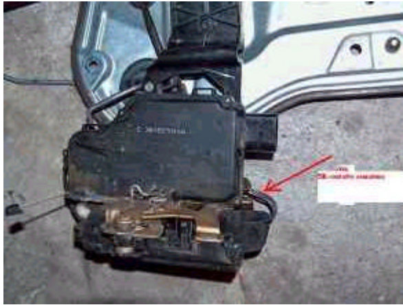
foto micro-interruttore nella serratura.
